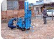
ボーリング機で、土壌試料を採取します。
