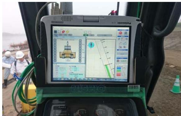
実際の盛土工に使用する“MGブルドーザ”に乗車体験し、モニター画面に表示される施工情報の確認しました。
