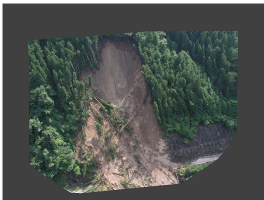
図3-23 斜面表面形状 3次元モデル（正面）
