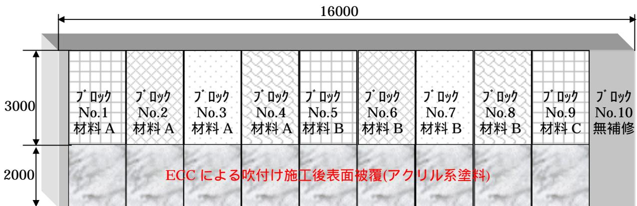
図-1 施工ブロック割(約1800×5000mm/1ブロック) (単位：mm)
