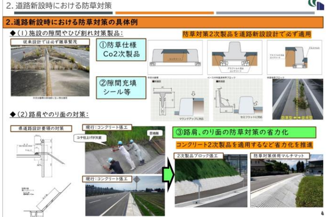
図-1 道路新設時の防草対策具体例
